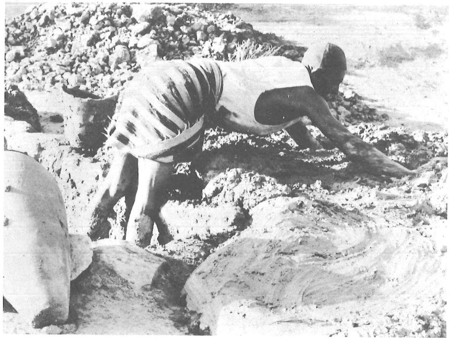
Ph. II.4 Préparation de l'argile. Un aide sort l'argile de la fosse et l'étend tout autour pour la faire égoutter sur l'aire de séchage.
